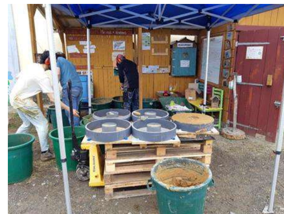
Chantier Bénévole pour la réalisation des briques en terre.
